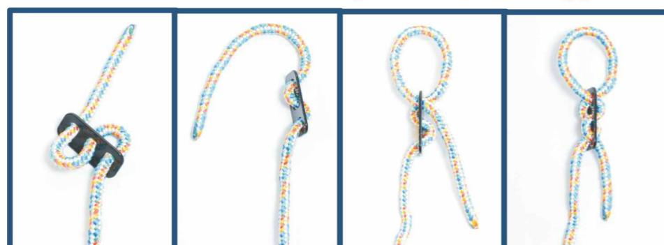
**Последовательная схема фиксации шнура вар. №2.**
